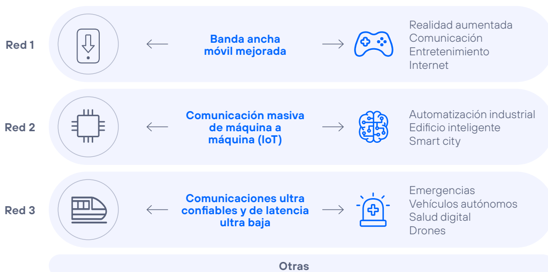
Figura 2. 5G network slicing: redes virtuales de extremo a extremo adaptadas a cada aplicación
