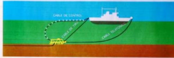
Enterramiento del cable.
