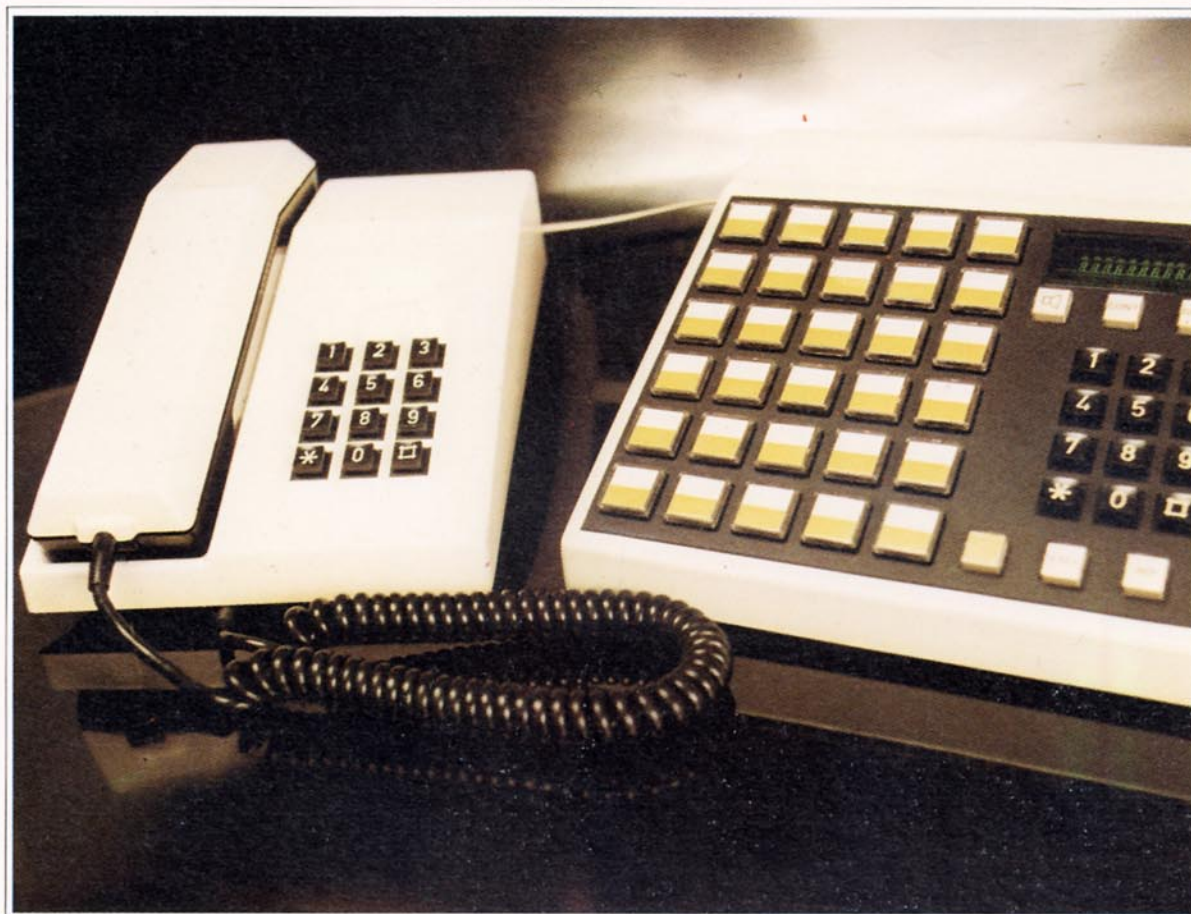
Teléfono electrónico de teclado de la línea TEIDE y marcador automático para sesenta números.
