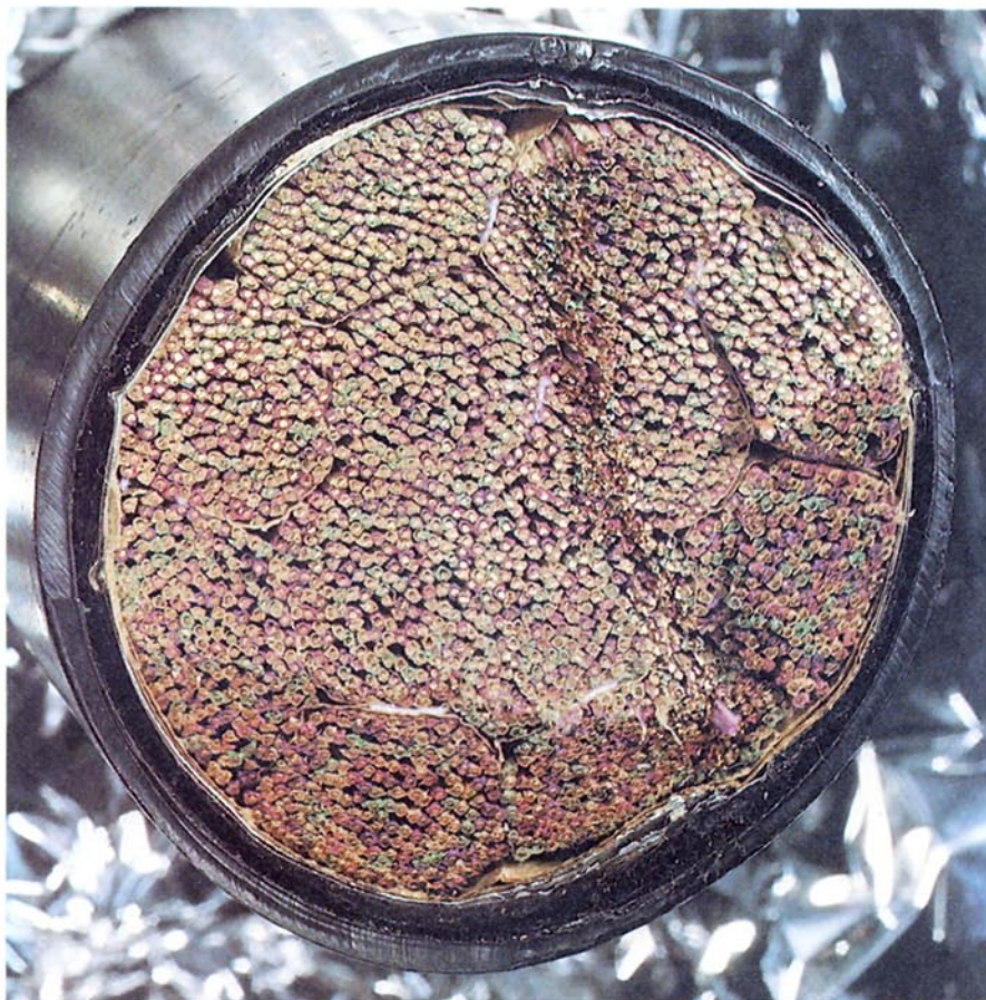
Sección transversal de un cable de pares.
