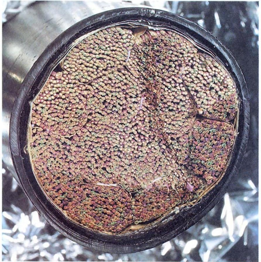
*Sección transversal de un cable de pares.*
