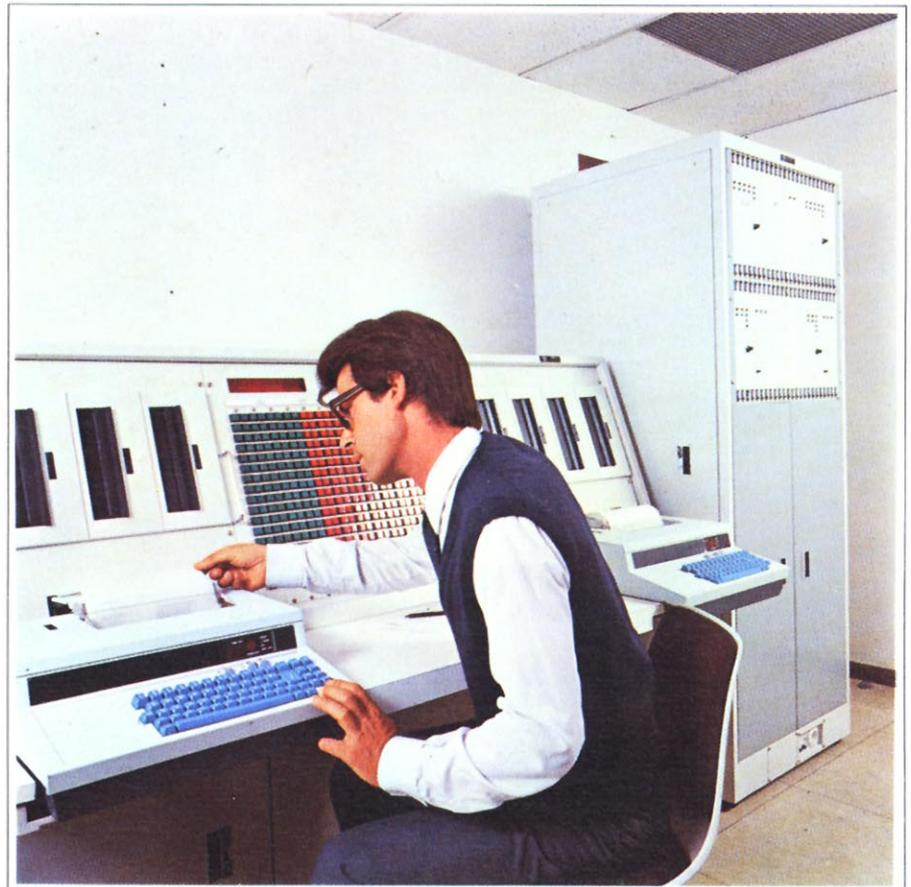
*Centralita Automática Privada de Conmutación Electrónica «UPCE-101», primer desarrollo nacional en el campo de las centralitas electrónicas, dotada de control con microprocesador.*
