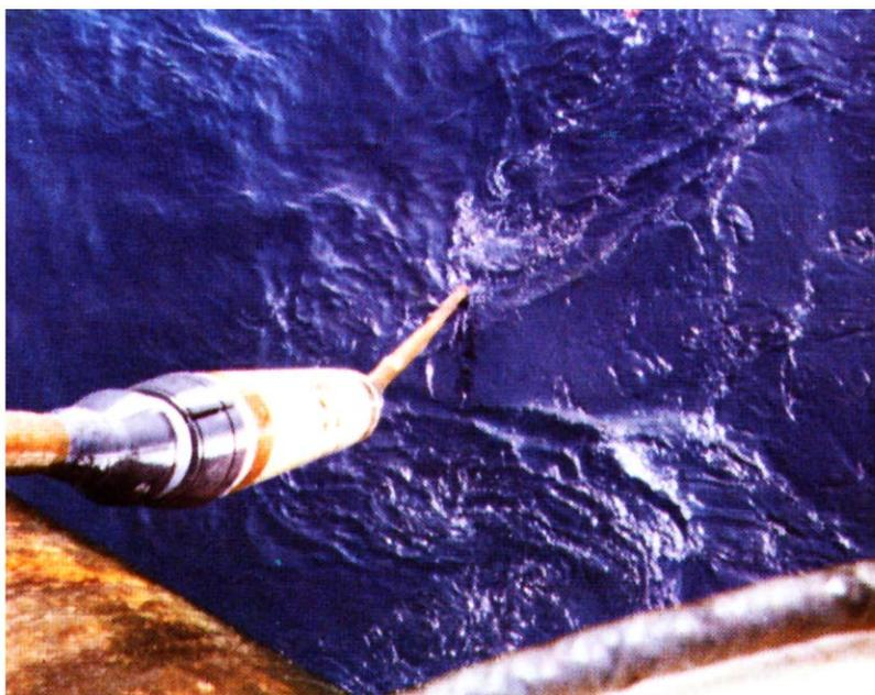
*Repetidor de cable submarino.*
